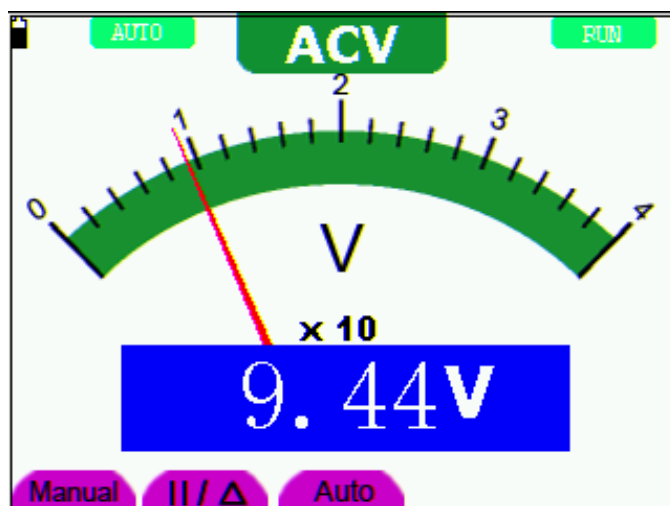
圖 26：交流電壓測量介面
