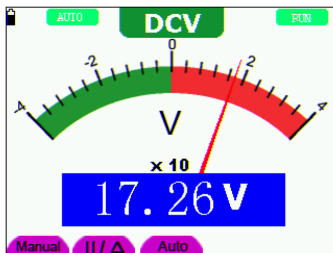
圖 25：直流電壓測量介面
