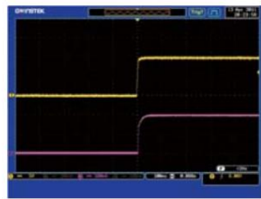
CC優先功能有效限制突波電流的發生，供電電壓時的突波電壓上升至 LED 正向電壓
