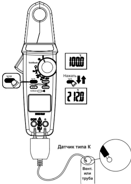
Переведите переключатель в нужное положение и нажмите кнопку выбора функций, чтобы выбрать функцию измерения. (°C / °F)
